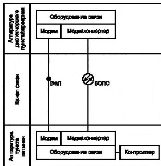
Рисунок 4 — Схема проводного канала связи
